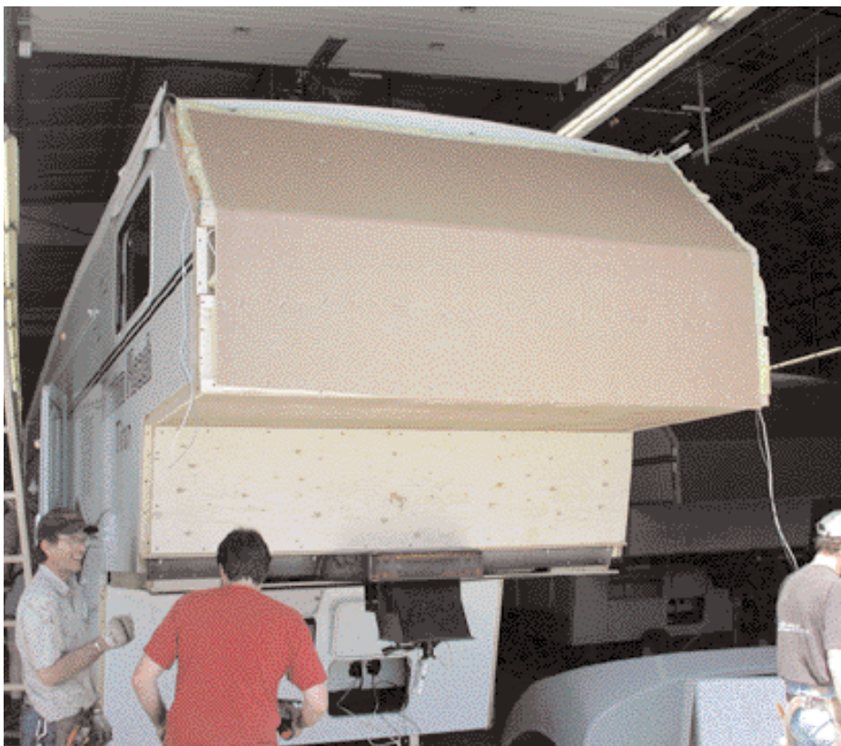
LES PIÈCES AVANT ET ARRIÈRE DES CARAVANES SONT SOUVENT CONSTITUÉES D'UNE PIÈCE DE FIBRE DE VERRE MOULÉ QUI VIENT SE SUPERPOSER AUX MURS EXISTANTS.
