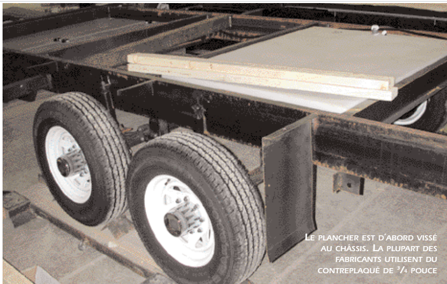
APRÈS AVOIR INSTALLÉ LES ESSIEUX, LA SUSPENSION, LES ROUES, LES RÉSERVOIRS, LE CÂBLAGE ÉLECTRIQUE ET LA TUYAUTERIE POUR LE GAZ PROPANE, ON MONTE LES MURS ET LA TOITURE.
